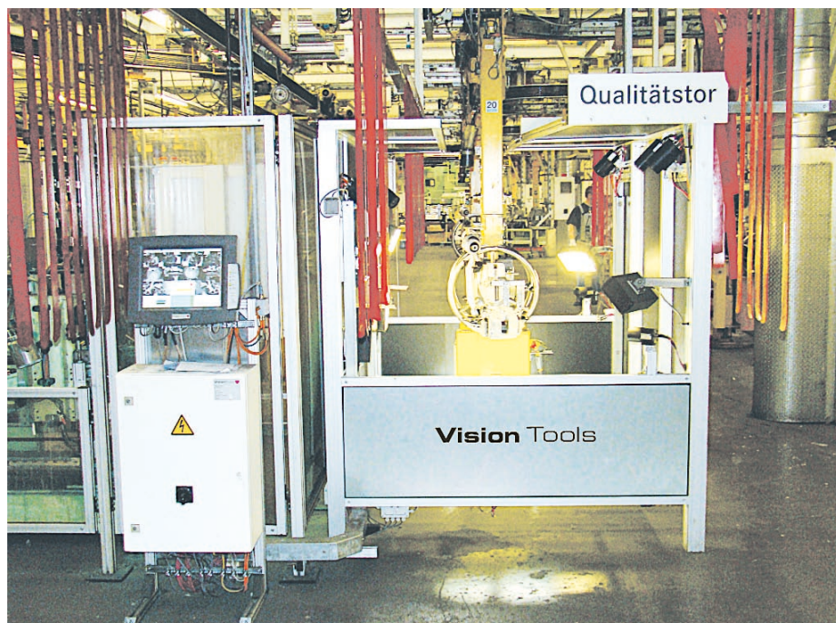
Kamerabestücktes Qualitätstor zur Kontrolle von PKW-Vorderachshälften
