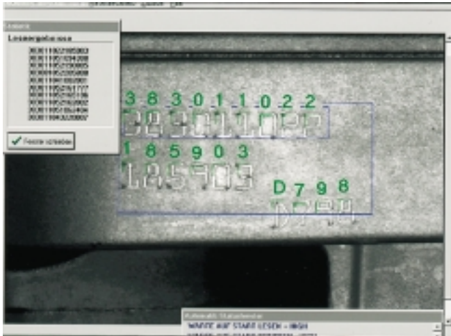
Bild 2. Die seitlich am Integralträger eingeritzten Guß- und Teiledaten werden vom Bildverarbeitungssystem automatisch gelesen und ausgewertet. Innerhalb des blauen Fangrahmens erkennt die Software die geritzten Zeichen und vergleicht sie mit den Soll-Daten (VisionTools GmbH, Waghäusel).
