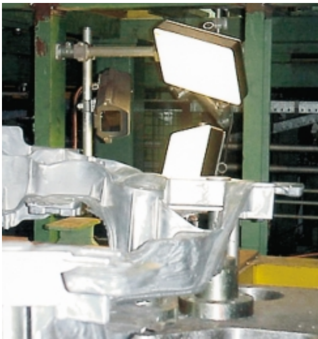
Bild 3. Im Hintergrund des Prüfplatzes sind die Beleuchtungen und die Kamera zu sehen. In der rauen Umgebung der Gießereiöfen und Druckgießmaschinen arbeitet das Bildverarbeitungssystem von Vision Tools störungsfrei (VisionTools GmbH, Waghäusel).
