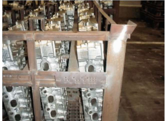
Bild 2. Auch nach den Wärmebehandlungen der Zylinderköpfe ist die codierte Information von der Kamera eindeutig zu bestimmen (VisionTools GmbH).
