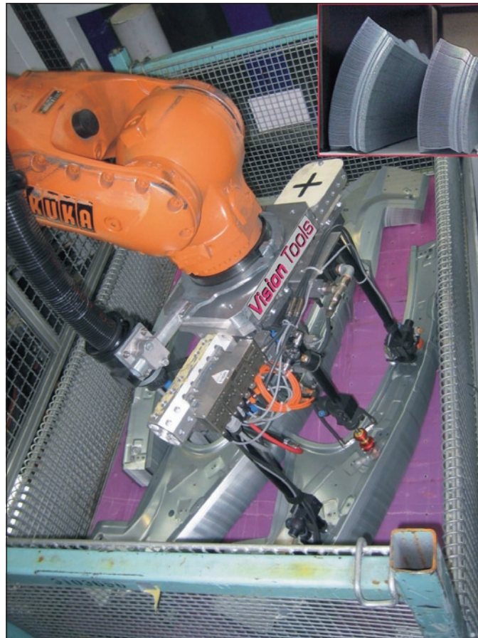
Abb. 2: 3D-Lageerkennung bei unbekannt gestapelten Teilen (Standardsituation). Das System funktioniert auch für „wild“ abgelegte Teile.
