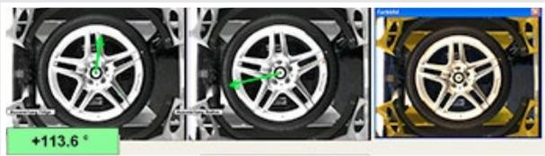
Um Rundlauf toleranzen eines Reifens auszugleichen, wird der Reifen auf der Felge um genau den Winkel weitergezogen, bis die Abweichungen des Rundlaufs in horizontaler und vertikaler Richtung ausgeglichen sind.
